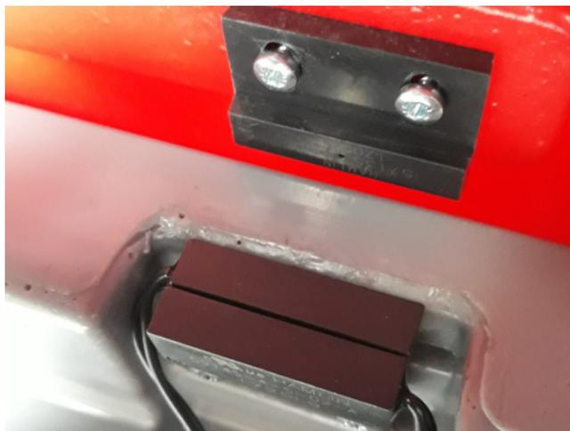
**Abbildung 168: Positionierung der Magnete und der Reed-Relais**
