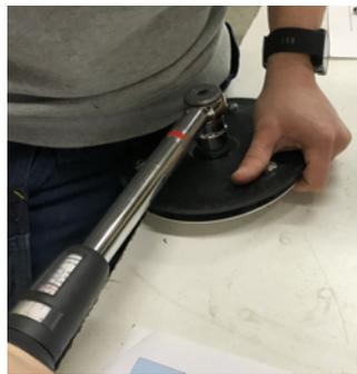
11. Setzen Sie die Schraube in die Achse.
