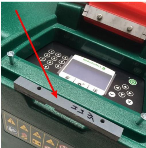
3. Wenn Sie den Abstandshalter mit 2 mm platziert haben, schließen Sie den Deckel und drücken Sie ihn sanft nach unten, sodass der Deckel sicher den Abstandshalter berührt.
