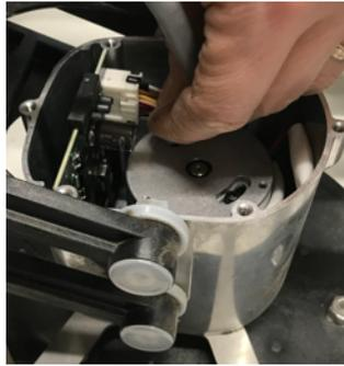
7. Überprüfen Sie den Innenraum des Motors auf sichtbare Beschädigungen. Prüfen Sie die Feuchtigkeit und trocknen Sie gegebenenfalls.
