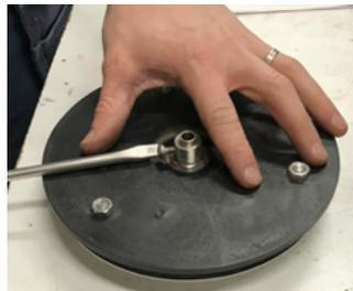
12. Setzen Sie das Bauteil wieder auf die Schneidekopfachse auf. Achten Sie darauf, dass die unten abgebildete Schraube die ebene Fläche der Schneidekopfachse berührt.
