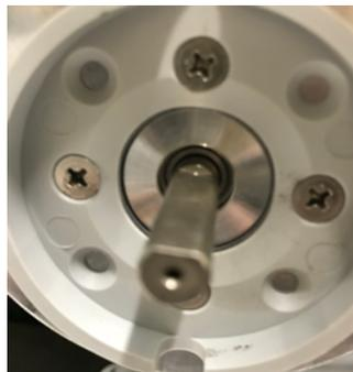
13. Ziehen Sie die Schraube mit 6 Nm an der Achse an.
