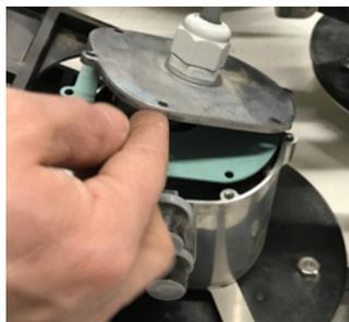
6. Ziehen Sie die elektrischen Anschlüsse ab.
