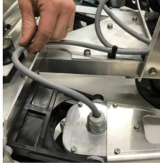
2. Reparieren Sie Beschädigungen der Ummantelung mit einem Klebeband.
