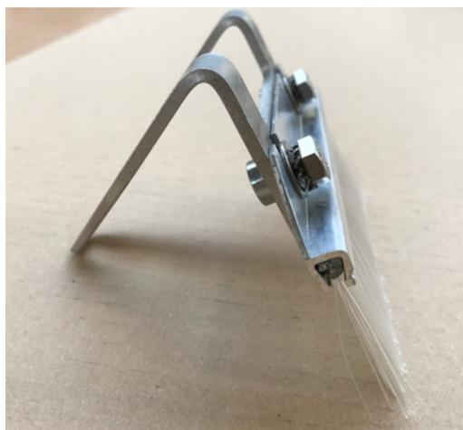
4. Schrauben Sie die Bürsten mit der flachen Unterlegscheibe neben der Bürste und der gewellten Unterlegscheibe unter dem Schraubenkopf an die Halterung. Das Drehmoment sollte 12 Nm betragen.
