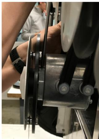
2. Lösen Sie die Schraube an der Achse wie unten abgebildet.
