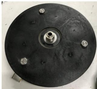
9. Kleben Sie die Unterlegscheibe mit etwas Klebstoff an der Gewindeachse fest.
