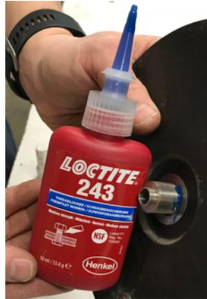
10. Setzen Sie die sechseckige Unterlegscheibe ein. Ziehen Sie sie mit 20 Nm an.
