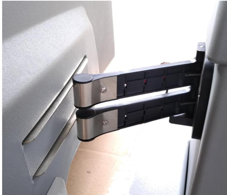
Abbildung 55: Korrekte Positionierung der Ladestation und des Roboters
